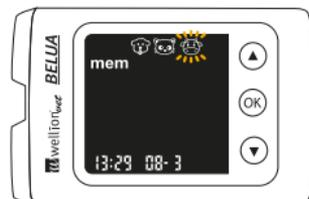
Schritt 4: Wählen Sie mit Hilfe der Pfeiltasten entweder Glukose oder Ketone aus und bestätigen Sie Ihre Wahl mit der OK Taste.
