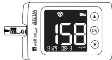
Entsorgen Sie den gebrauchten Teststreifen durch Betätigen der Auswurf-taste. Sie können den Teststreifen aber auch manuell herausziehen.
