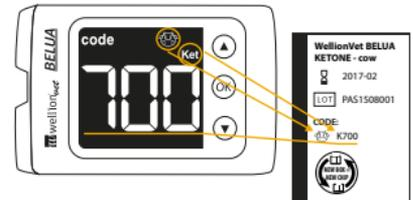
Schritt 4: Am Display des Messgerätes sind nun das Teststreifen- und Blutstropfensymbol zu sehen, um zu zeigen, dass es für die Messung bereit ist. In der rechten oberen Ecke des Displays steht „KET“. Das bedeutet, dass das Gerät nun für eine Ketonmessung bereit ist.
